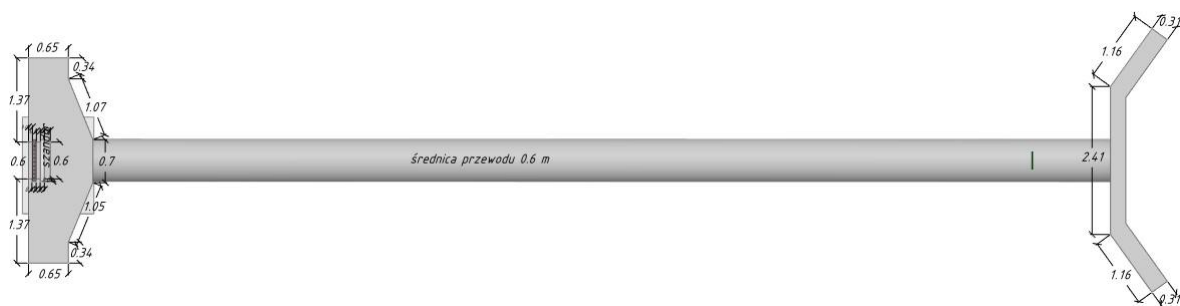
Rys. 4.18 Przekrój podłużny (a) i widok z góry (b) mnicha 6MN wraz z wymiarami
