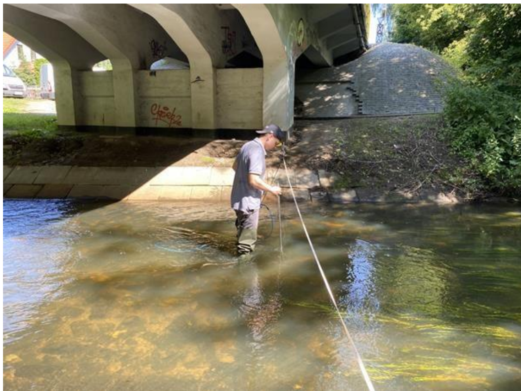
Fot. 5.3 Pomiary natężenia przepływu na rz. Utracie
