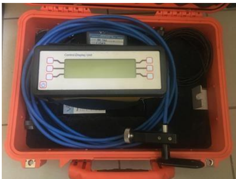
Fot. 5.4 Urządzenie do pomiarów prędkości wody w cieku – prądomierz elektromagnetyczny Valeport M 801 (dokładność pomiaru na poziomie \pm 0,5\% odczytanej wartości)
