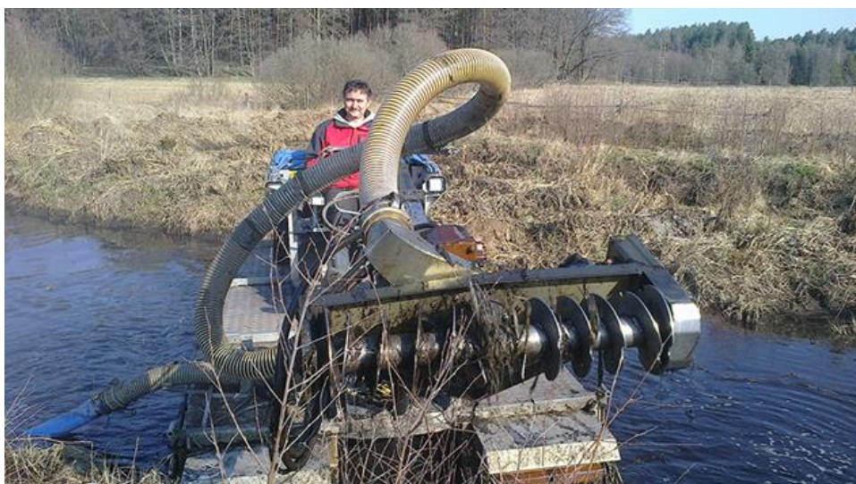
Fot. 4.13 Refuler – widok na osprzęt roboczy
