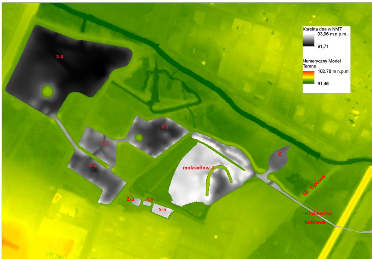
Rys. 5.10 Numeryczny Model Terenu z zaznaczonymi na czarno-biało fragmentami w których wprowadzono korekty wysokości dna do celów obliczeń pojemności w oparciu o Inwentaryzację Geodezyjną Parku wykonaną w 2021r.
