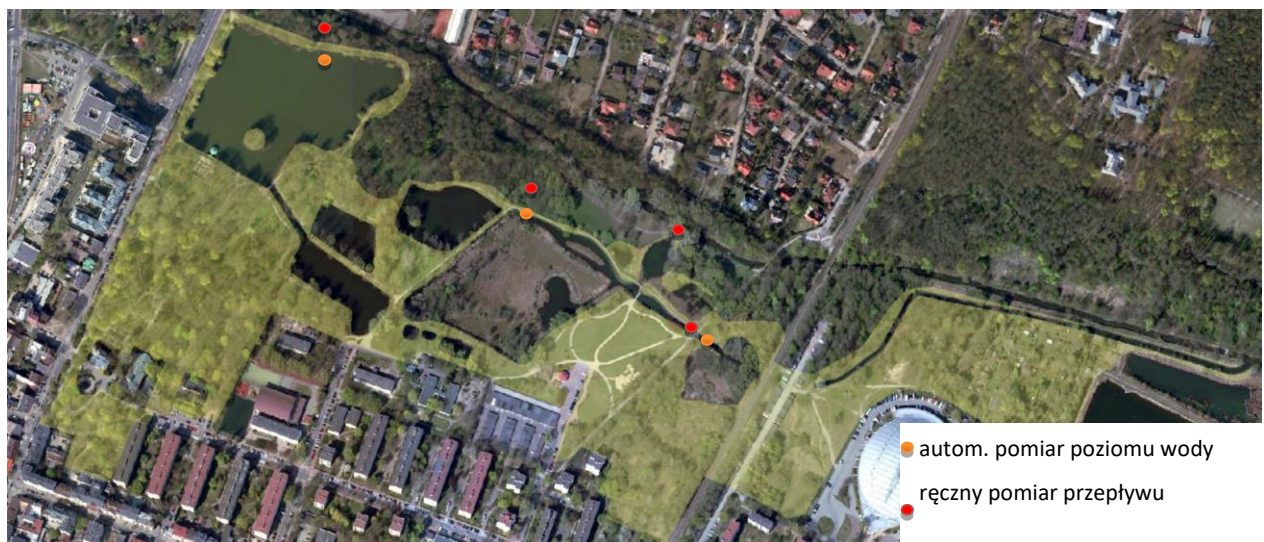
Rys. 5.18 Lokalizacja pomiarów stanu wody i przepływu do celu analizy strat na przesiąki
