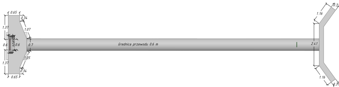
Rys. 4.18 Przekrój podłużny (a) i widok z góry (b) mnischa 6MN wraz z wymiarami
