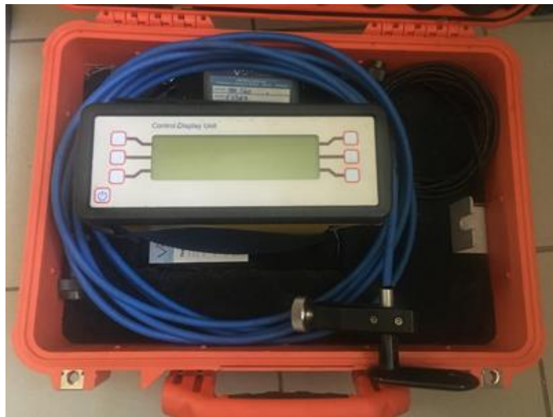
Fot. 5.4 Urządzenie do pomiarów prędkości wody w cieku – prądomierz elektromagnetyczny Valeport M 801 (dokładność pomiaru na poziomie \pm 0,5\% odczytanej wartości)
